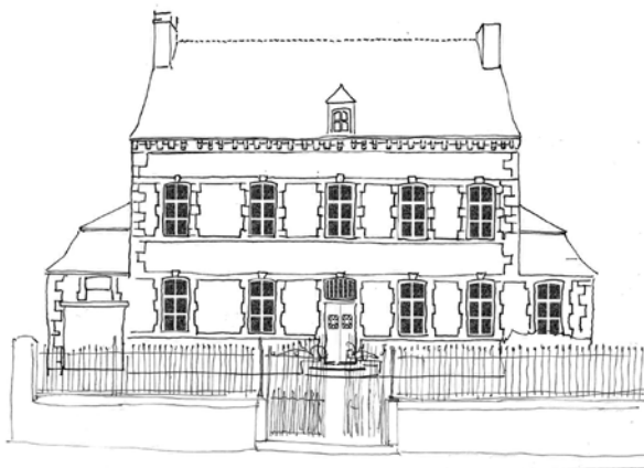
Linteaux cintrés à clé, montants harpés Presbytère de Ragnies
